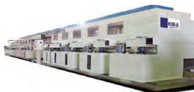
無排水めっき処理システム No-drainage plating system
