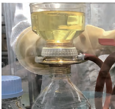
原料の精製：エアータイトボックス内でのイオン交換樹脂による NaI 原料の超高純度化処理工程 Purification of raw materials: Treatment process for ultra-high purification of raw NaI material through an ion exchange resin in an airtight container
