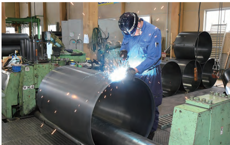
ロール巻加工を終え、仮溶接作業 Tack welding after completion of roll forming
