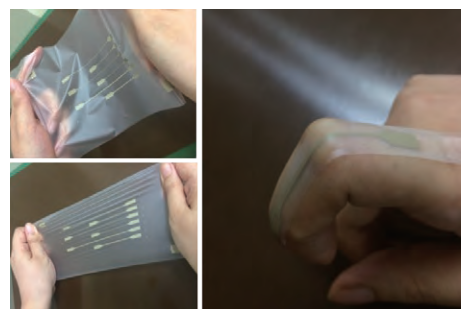
ストレッチャブル（伸び縮みする）基板…開発品 Product developed with stretchable PCB
