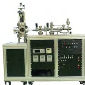
飛行時間型原子散乱表面分析装置 (TOFLAS-3000) Time of Flight Low Energy Atom Scattering Spectroscopy (TOFLAS-3000) 飞行时间型原子散乱表面分析仪器 (TOFLAS-3000)
