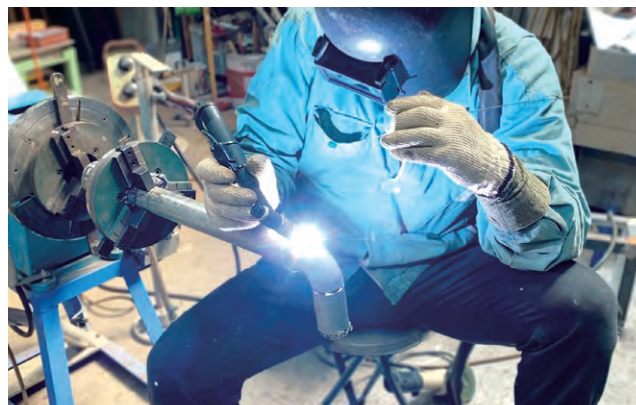
自社開発の裏波溶接装置を使用 We use an internally developed uranami welding device
