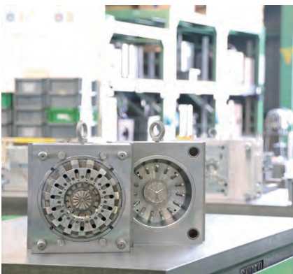
全周スライド型 Mold that slides all around
