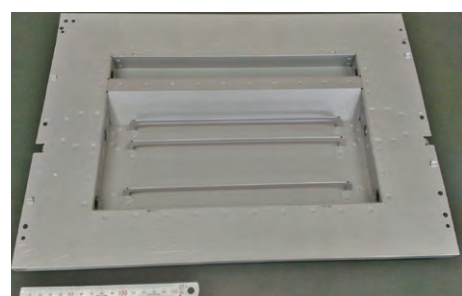
スポット溶接をプレスカシメ工程に変更の製品 Product changed from spot welding to press crimping
