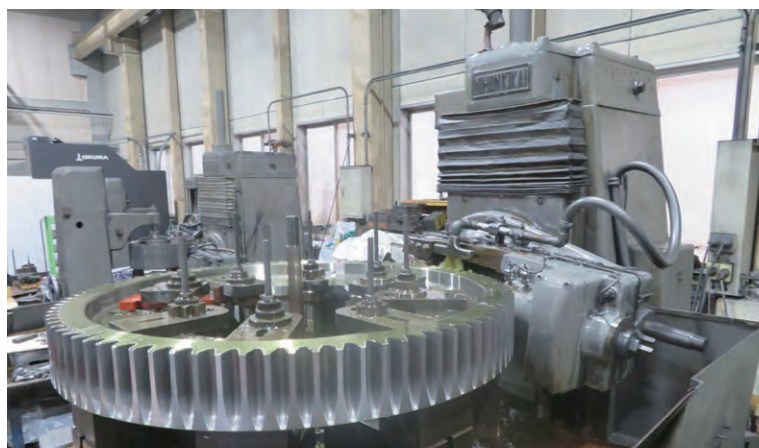
歯切り加工（φ10mm～φ1800mmまで加工可能） Gear cutting (we can handle φ10 mm to φ1,800 mm)
